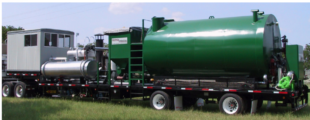
Figura 1. Equipo para fabricación de betún-caucho
