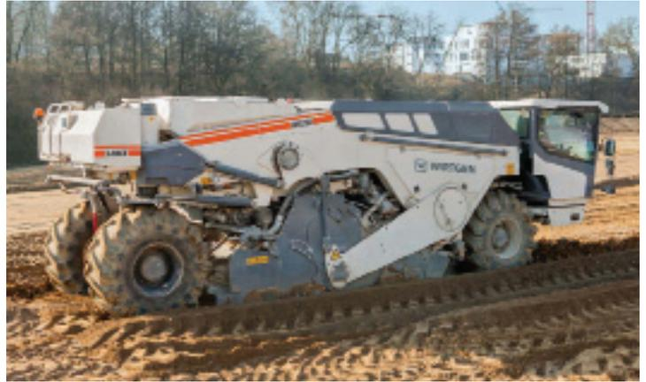
Dosificadora y estabilizadora integradas.
