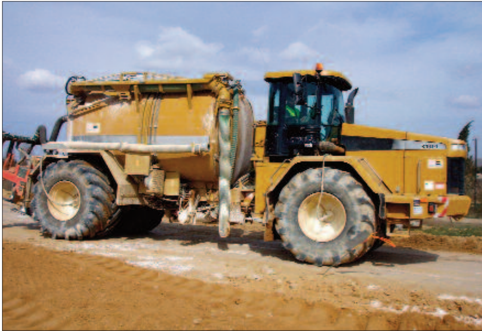
Figura 6.6 Equipo de distribución de lechada de cal
