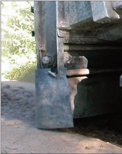
Figura 8.1 Detalle de faldón de protección de un distribuidor de conglomerante
