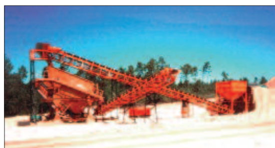
Figura 5.5 Criba fija vibrante con tolva de alimentación
