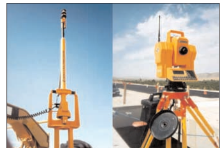
Figura 5.32 Estación total robotizada y prisma activo del sistema 3D
