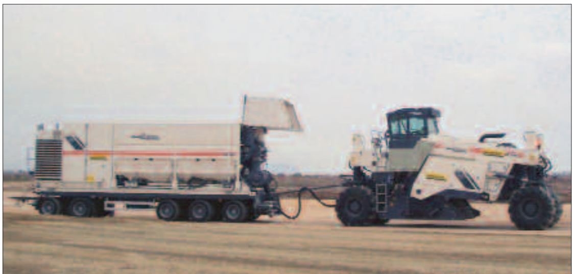
Figura 5.15 Equipo de estabilización por vía húmeda con depósito para conglomerante de 25 m 3
