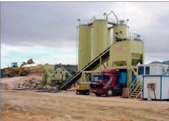
Figura 5.36 Planta de mezcla de 600 t/h con tres tolvas dosificadoras y tolva de regulación
