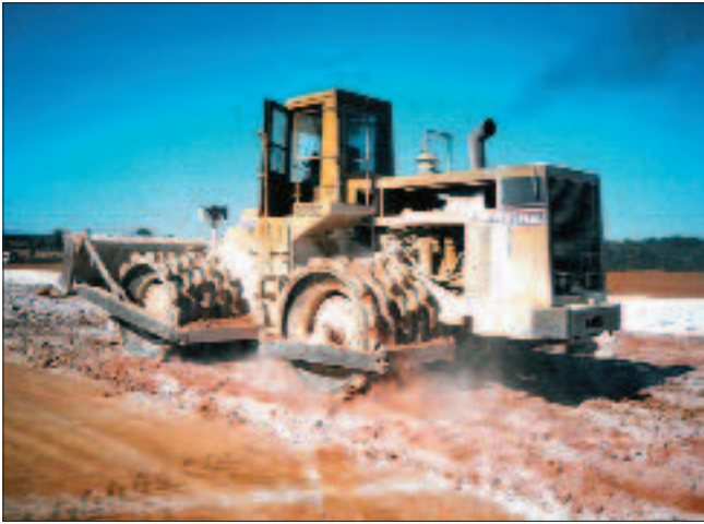
Figura 5.27 Rodillo tipo tamping foot con cuchilla de empuje
