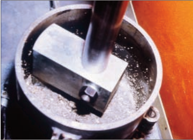
Figura 4.1 Compactación Proctor modificado
