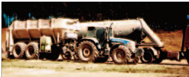
Figura 5.11 Distribuidor remolcado de conglomerante por vía seca en el momento de la carga desde la cisterna de transporte
