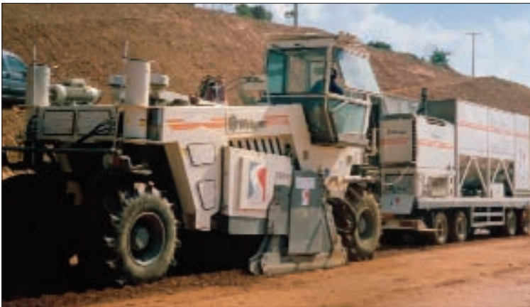
Figura 6.12 Equipo de estabilización
