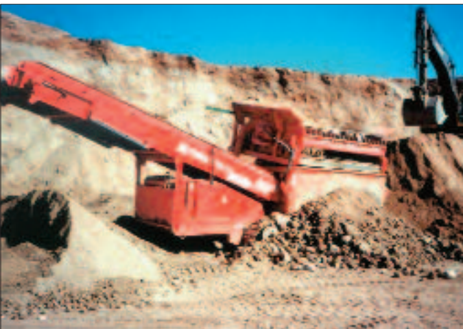
Figura 5.7 Criba vibrante sobre orugas con cinta transportadora de salida
