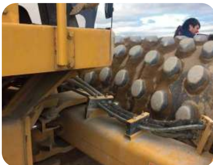
Figura 7.23.- Rodillo empleado en algunos países para compactar (nunca debe usarse para amasar)
