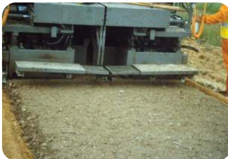
Figura 7.15.- Máquina recicladora con cemento y regla de extendido incorporada
