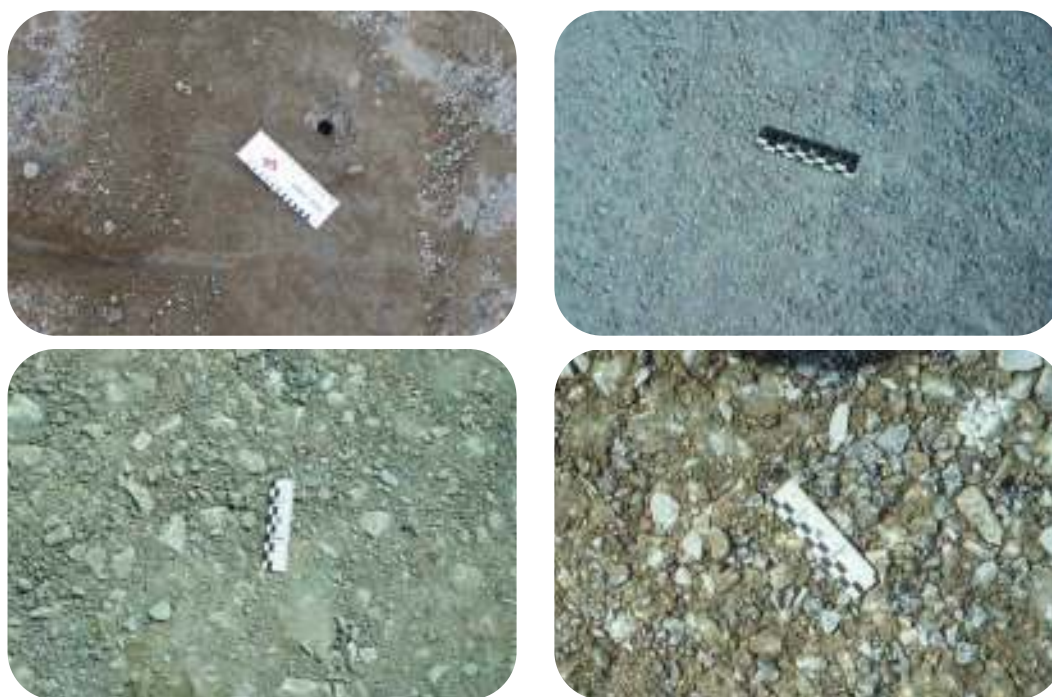
Figuras 8.18 a 8.21.- Diferentes acabados según la granulometría del material reciclado
