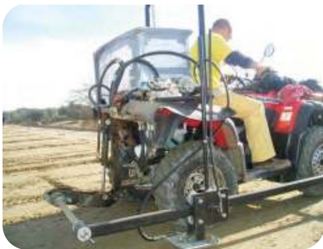
Figura A3.5 y A3.6. – Equipo de prefisuración sobre quad y sobre mini-retroexcavadora
