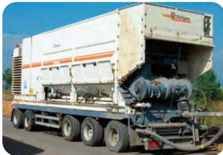
Figuras 7.5.- Distribuidor de cemento en lechada
