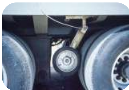
Figuras 7.6, 7.7 y 7.8.- Diferentes partes del distribuidor de cemento en lechada (sinfín de suministro ponderal, rueda que mide la velocidad de avance y ordenador de gobierno)
