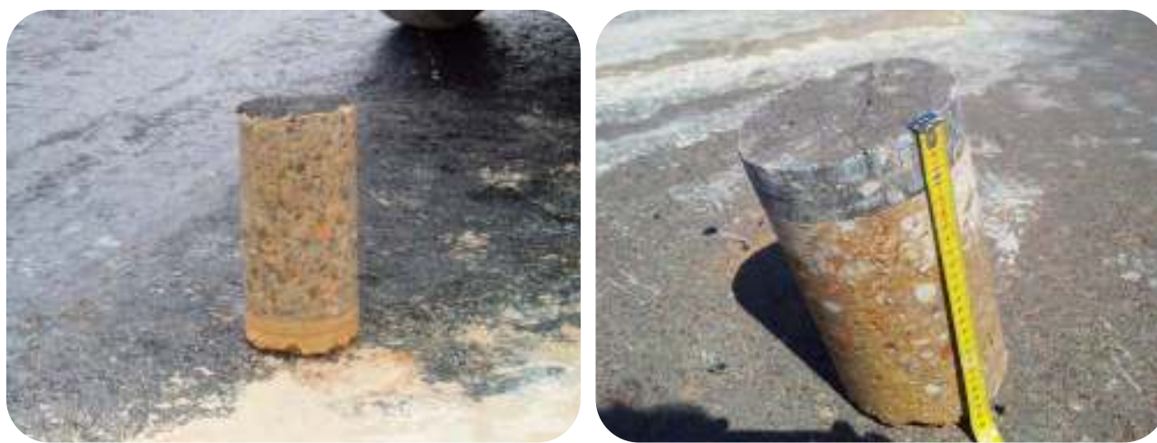
Figuras 1.25 y 1.26- Testigos extraídos en diferentes pavimentos reciclados
