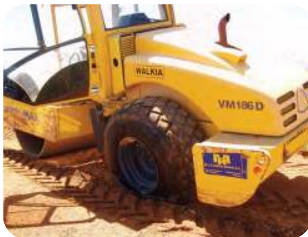
Figura 8.45.- Imprevistos: Pinchazo de una rueda de un rodillo
