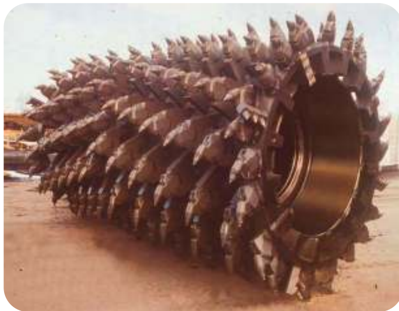
Figura 7.16.- Rotor de reciclado con sus picas
