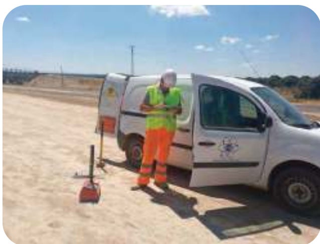
Figuras 9.7 y 9.8.- Medición de la densidad con sonda nuclear
