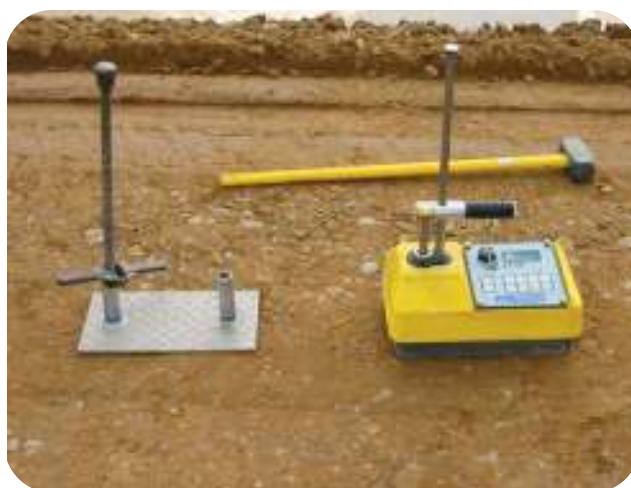
Figuras 9.7 y 9.8.- Medición de la densidad con sonda nuclear
