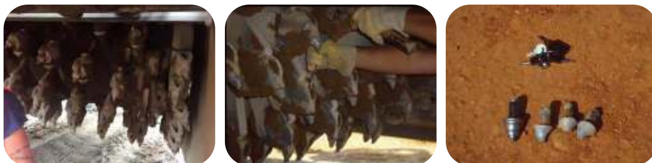
Figuras 7.17 a 7.19.- Rotor, cambio de picas y detalle de estas
