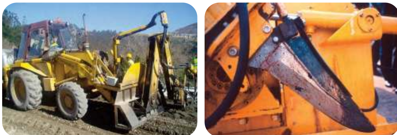
Figuras A3.1 y A3.2. – Vista general del equipo CRAFT® y detalle de su elemento de corte
