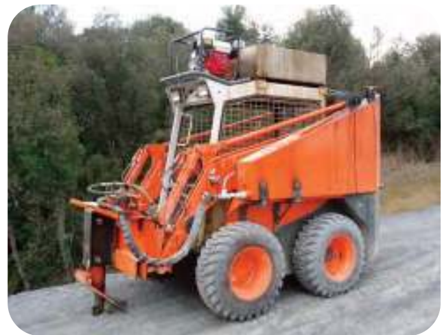
Figura A3.5 y A3.6. – Equipo de prefisuración sobre quad y sobre mini-retroexcavadora
