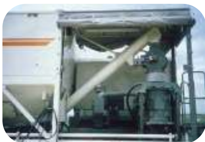
Figuras 7.6, 7.7 y 7.8.- Diferentes partes del distribuidor de cemento en lechada (sinfín de suministro ponderal, rueda que mide la velocidad de avance y ordenador de gobierno)
