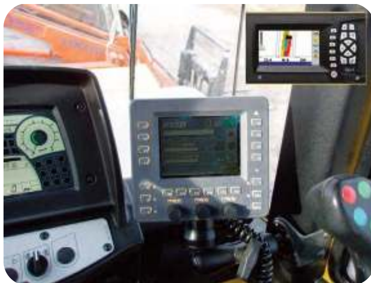
Figura 8.12.- Compactometro para ayudar al operario
