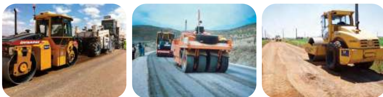
Figuras 7.20 a 7.22.- Rodillo vibratorio, de neumáticos y el rodillo más común en España en el reciclado
