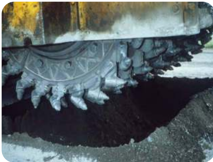
Figura 5.1.- Rotor con picas de un reciclado in situ en las pruebas de granulometría
