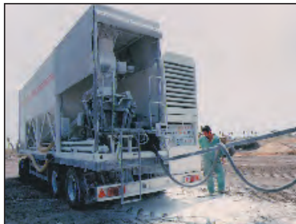
Fig. 17. Mezclador móvil agua-cal WM400
