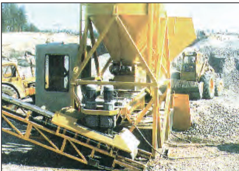
Fig. 18. Central mezcladora de arcilla de doble eje.(Belmix)
